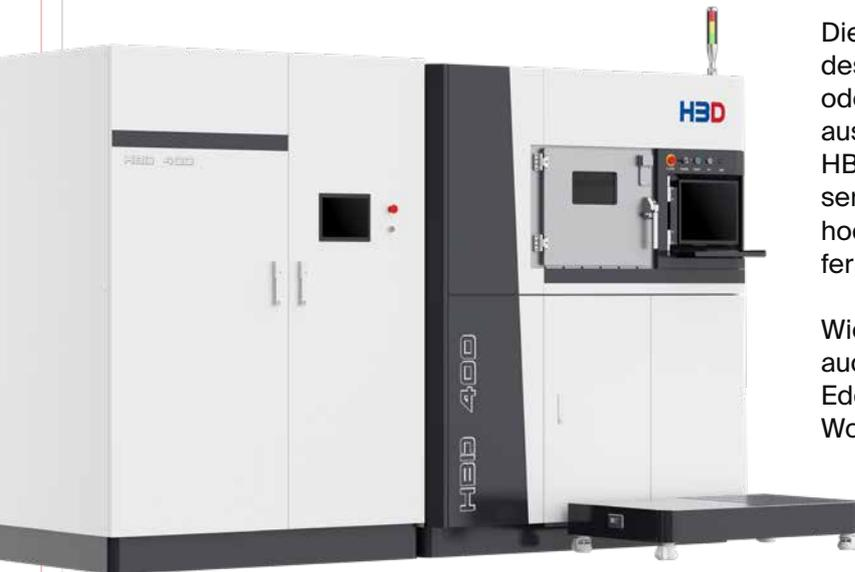
Die HBD400 bildet mit der HBD350 das Mittelfeld des Herstellers. Die Anlage kann wahlweise mit 4 oder 6 Lasern, mit je 500 W oder 1000 W Leistung ausgestattet werden. Darüber hinaus gibt es die HB400 in einer Ausführung mit einem grünen Laser, welche vor allem für die Verarbeitung von hoch reflektiven Materialien wie Kupfer und Kupferlegierungen ausgelegt ist.
