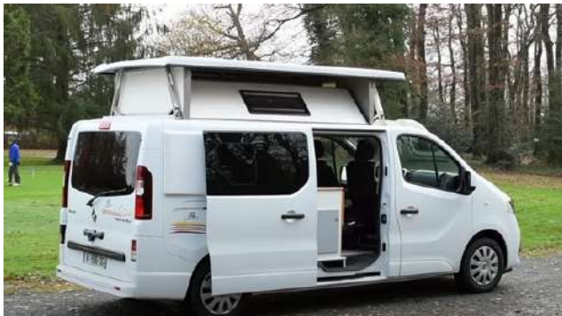
➔ Levée du toit d'un véhiculé aménagé, grâce à un système à ciseaux de part et d'autre, il est actionné par deux vérins électriques EasyE-Line synchronisés par une carte électronique
