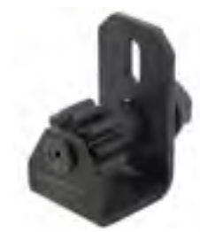
Chave de 11 dentes para alinhar cambota Medida: Parafuso hexagonal de 24mm Aplicação: DAF CF65/ CF75/ CF85/ F65/ F75/ F85/ F95/ XF95
