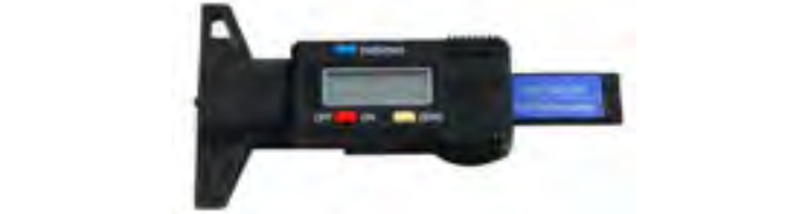
Medidor digital de profundidade Utilizado para medir a profundidade do piso dos pneus e das pastilhas de travões. Especificações: Gama de medição: 0-25,4mm Resolução: 0,01mm Display: LCD Medição em milímetros ou polegadas. Utiliza pilhas SR44/ LR44 de 1,4V (não incluídas).
