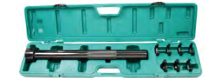
Removedor da barra de direção Estas ferramentas são especialmente projetadas para os tirantes internos que são inacessíveis para o ajuste. A chave longa pode ser facilmente usada com sete chaves de bocas, tamanho: 1-3/16"; 1-1/4"; 1-5/16"; 1-7/16" e 14mm; 17mm; 33,6mm O tirante interno pode ser facilmente removido e instalado deslizando a chave longa sobre a extremidade do tirante e conectando-o à chave bocas
