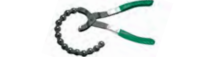
Corta tubos de escape Não utilizável em tubos de aço inox Medidas: 19 a 76mm de diâmetro
