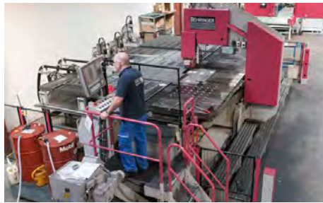
Plattensäge bis 2 x 6 m mit beweglichem Schneidkopf Plate saw up to 2 x 6 m with movable cutting head
