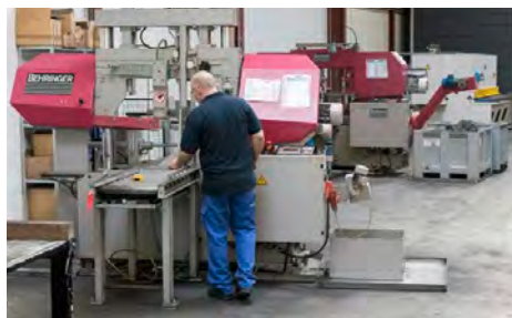
Stangensägen für Rundstäbe von 6 m Länge, bis zu einem Durchmesser von 450 mm Bar saws for round bars from 6 m long, up to 450 mm
