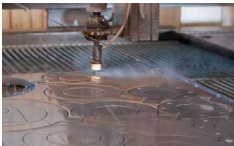
Découpe jet d'eau Materials blanks using water jet technology
