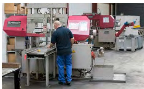
Scies pour découpes de barres rondes sur 6 m de long, jusqu'à un diamètre de 450 mm Bar saws for round bars from 6 m long, up to 450 mm
