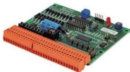
Abbildung 08: Mehrkanal-Steuerkarte
