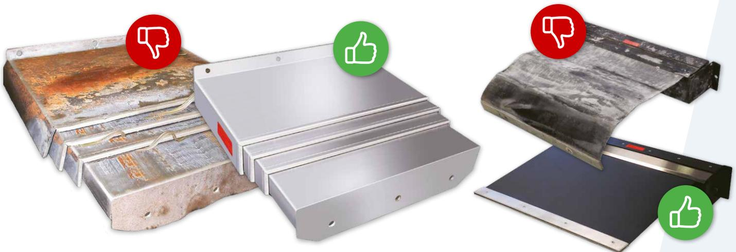
Alt vs. Neu: Deutlich sichtbar der Unterschied – links bzw. oben die stark beanspruchten, beschädigten Schutzlösungen, rechts bzw. unten die fachgerecht instand gesetzten und einsatzbereiten Komponenten.
