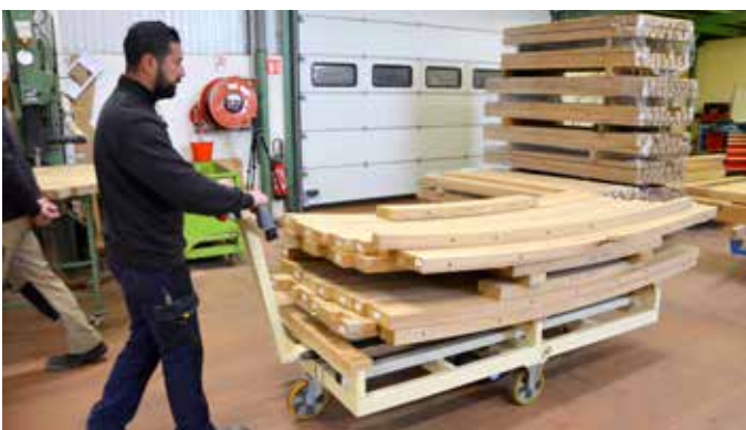
Kraftsparender Transport: Das AWD® 150 erleichtert das Bewegen schwer beladener Transportwagen und sorgt für ergonomischere und effizientere Arbeitsabläufe.
