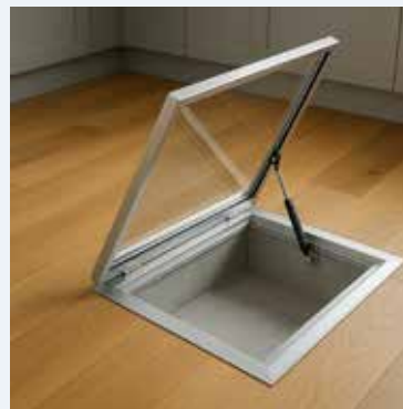
Die Gasfeder sorgt für präzise Bewegung und zuverlässigen Halt: Türen lassen sich leichtgängig sowie geräuscharm bedienen und bei Klappen hält die Ausschubkraft das Gewicht im Gleichgewicht.
