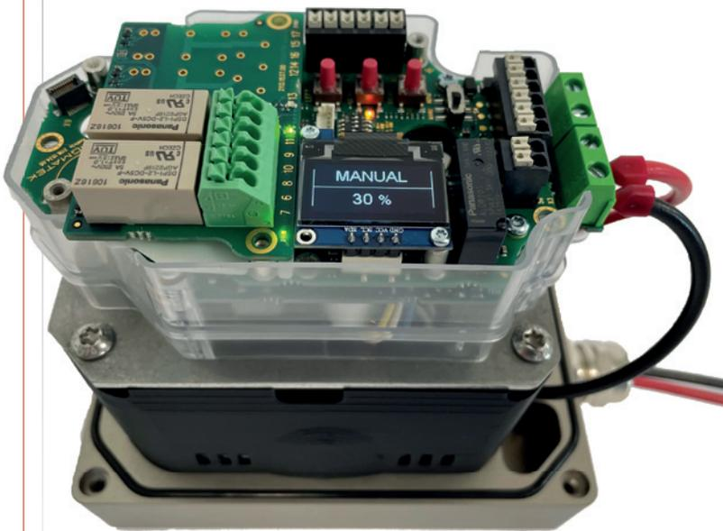
Neben einem WLAN-Modul und zahlreichen anderen Weiterentwicklungen verfügt der Tensor 2 nun über ein OLED-Display.
